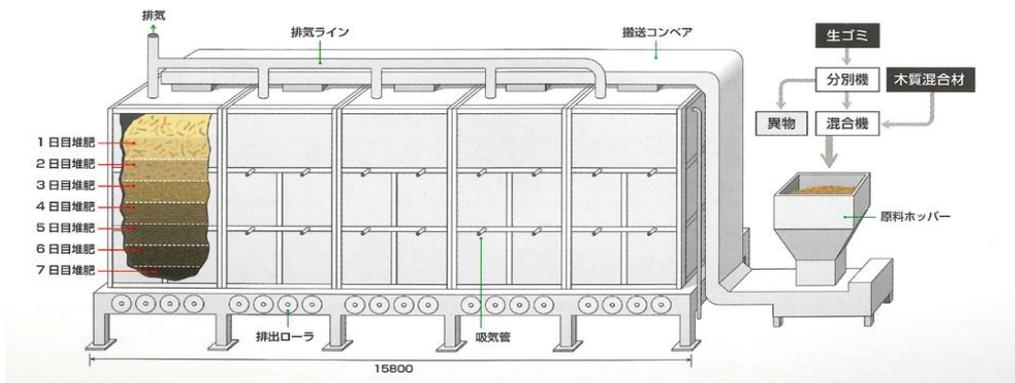
图 9: 密闭型发酵槽示意图
