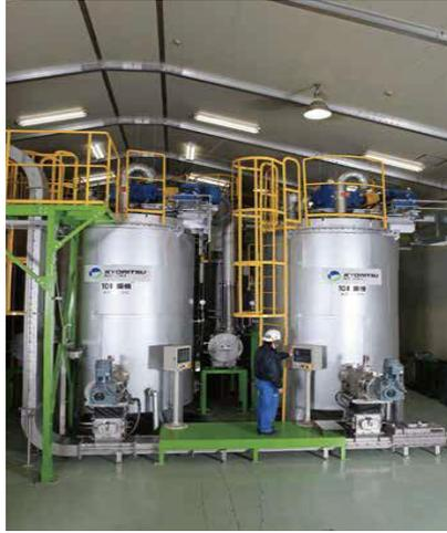
图 8: 常压烘干机产品示意图
