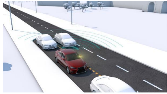
图 24、25: ARC1.01 77GHz 毫米波角雷达产品及 DOW 功能示意图
