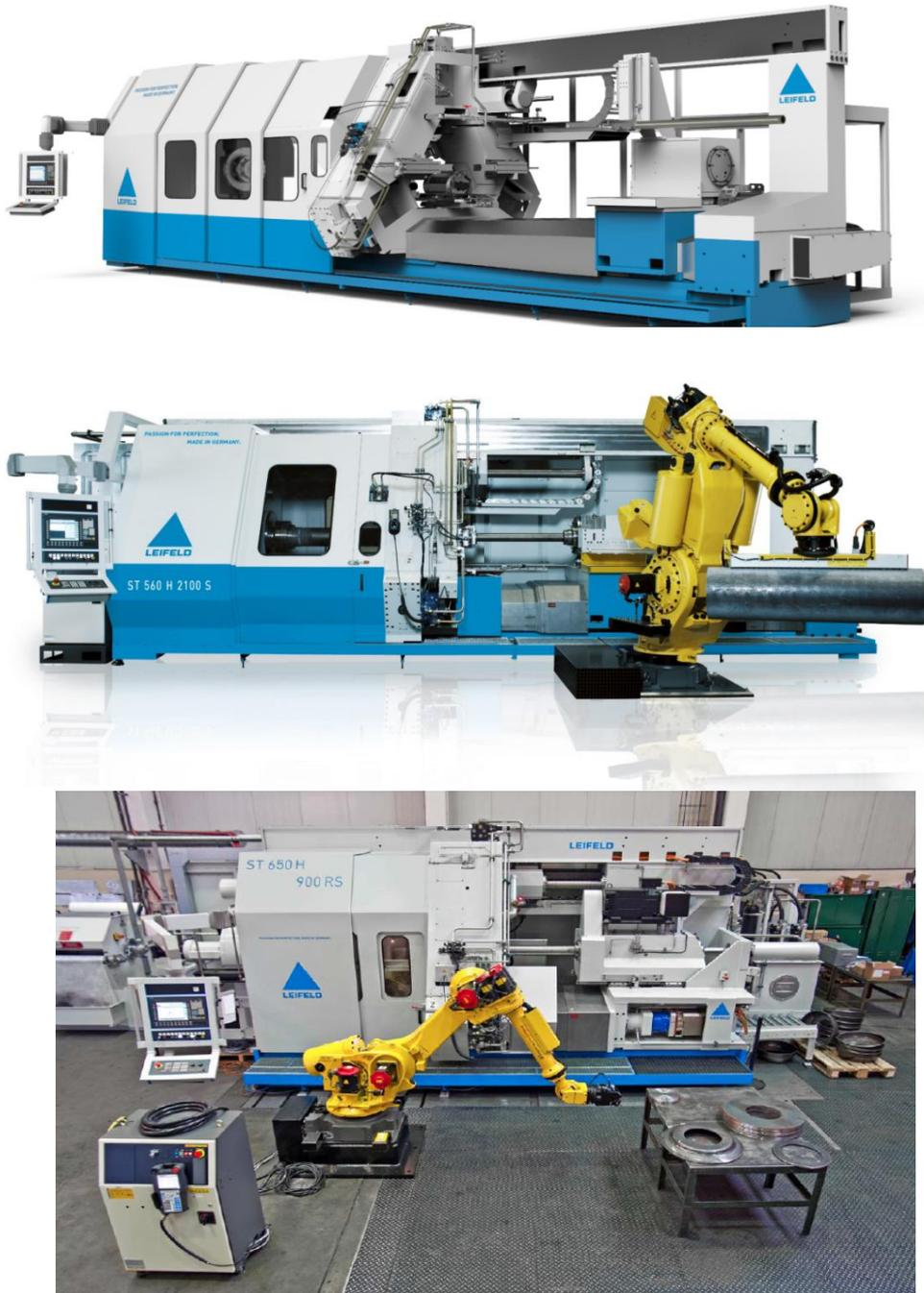
图 6: ST-RS 轮辐旋压机宣传图
